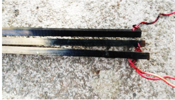
Figure 13 : Colmatage des batonnets sur la station amont - 2025
