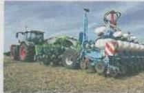
Le mélange peut être semé avec une trémie à l'avant pour la féverole, le striplif et un semoir monograinne pour le colza.
